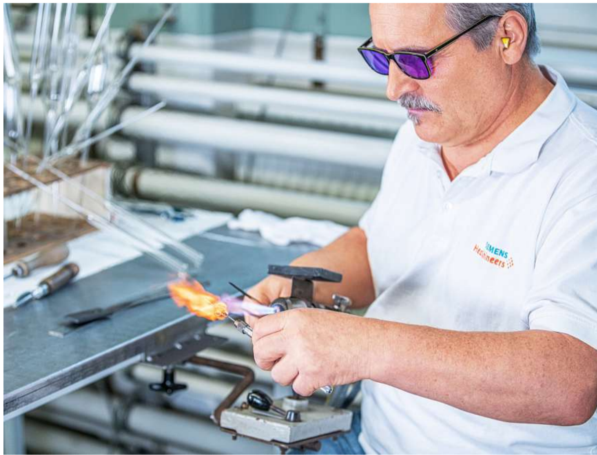
Im Siemens-Röntgenwerk in Rudolstadt hat Glasbläsermeister Jörg Linke die 125 Jahre alte Röntgenröhre originalgetreu nachgebaut.
